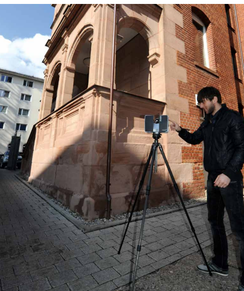
Von der Realität in die Virtualität: Ein Mitarbeiter erstellt einen 3D-Scan des Institutsgebäudes. Architekten können diese Daten mit CAD-Informationen kombinieren und so ihre Entwürfe lebensecht präsentieren.
